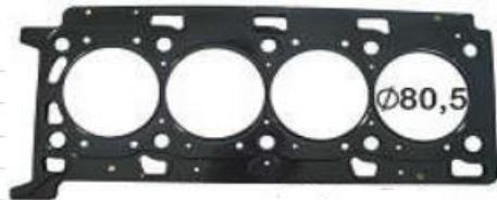
15802 SC - 1,20 MM - CIL. 80,5 MM 15802 MLS- 0,75 MM - CIL. 80,5 MM JTA CABEÇOTE
