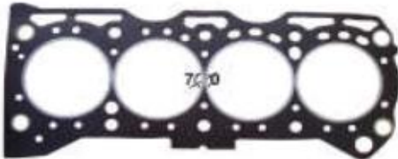
93102 SC - 1,6 MM - CIL. 76 MM 93102 KT - 2,6 MM - CIL. 76 MM JTA CABEÇOTE
